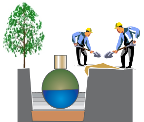
material de umplură în straturi compactate / inundate
